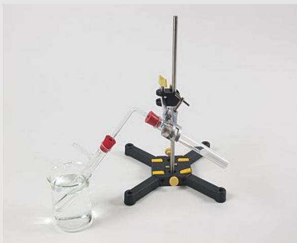
Производство полиамида путем реакции конденсации.
